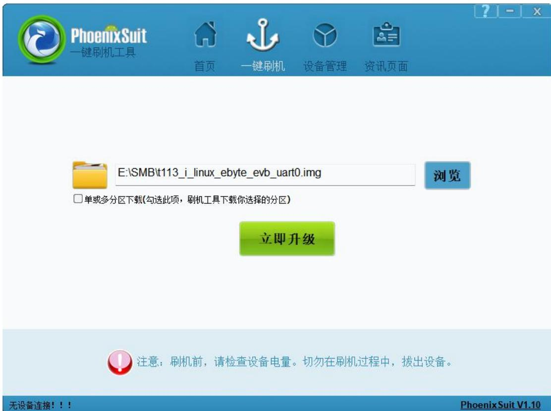
用户不用管立即升级按钮，只要在打开该软件，选择好烧写镜像，usb 连线正常连接后，一旦待烧写小机进入烧写模式，会自动识别并询问烧写情况：
